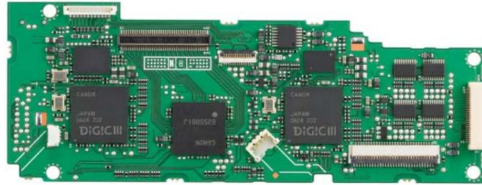
先進の知能。高精細・高速画像処理、デュアル DIGIC III搭載
