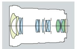
16mmから35mmまでの超広角域をカバーする大口径ズームレンズです。研磨・レプリカ・ガラスモールドの3枚の高精度非球面レンズを採用。ワイド側でも画面のすみずみまでシャープな高画質を実現しました。さらにUDレンズを2枚用い、色収差も良好に補正。風景、報道など幅広く活躍する高性能レンズです。
